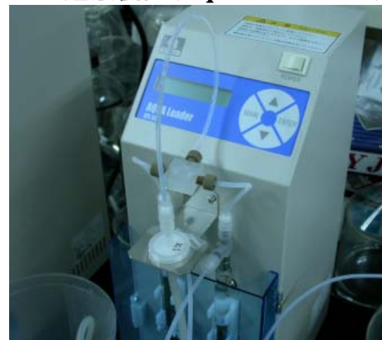
加圧送液装置 (Aqualoader/GLS)
