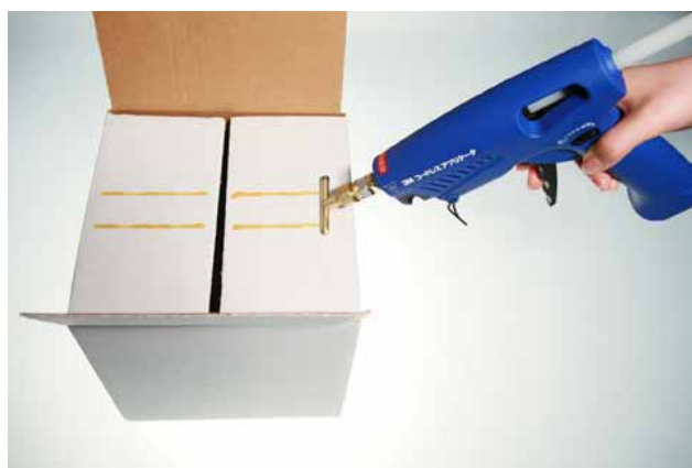
T型ノズルを使用した塗布風景
